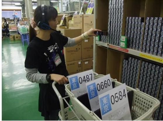
図表 2 音声認識システムを用いたピッキング作業のイメージ：(株)日通総合研究所撮影
