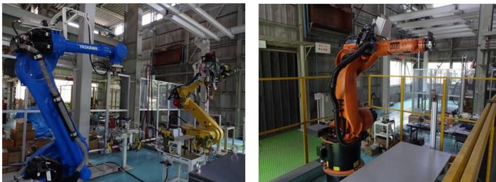
図表 4 ロボット溶接設備のイメージ 出所: (株)ウエノテクニカご提供
