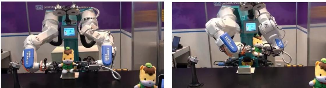
図表 7 ツインアームロボットシステムのイメージ 出所：㈱ウエノテクニカご提供
