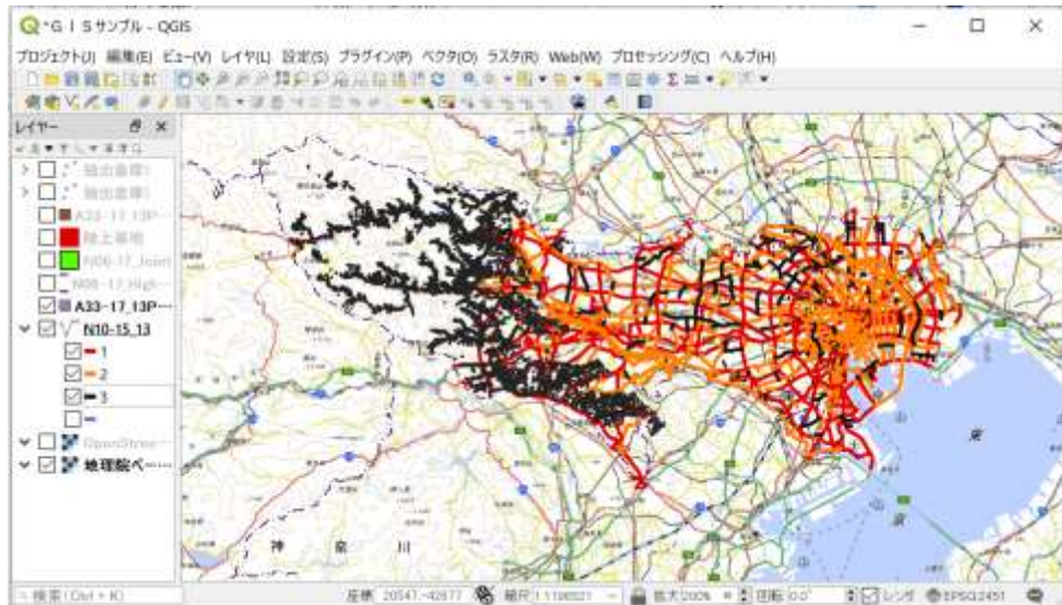
図7 QGISの操作例（東京都の土砂崩れ危険個所データを重ねている）
