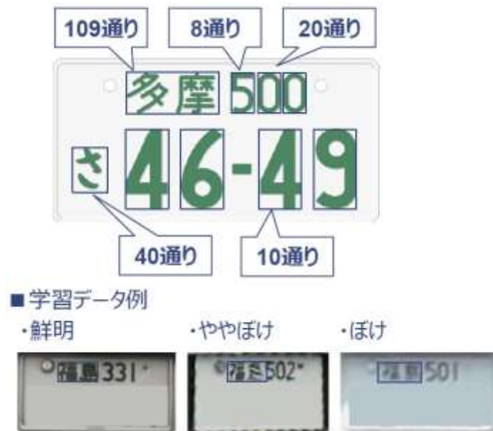
図 1 人工知能に学習させるナンバープレート画像のイメージ 出所:ニューラルポケット株式会社より提供
