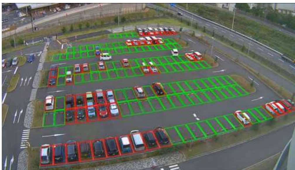
図 3 人工知能による駐車場の満空認識結果のイメージ 出所:ニューラルポケット株式会社より提供
