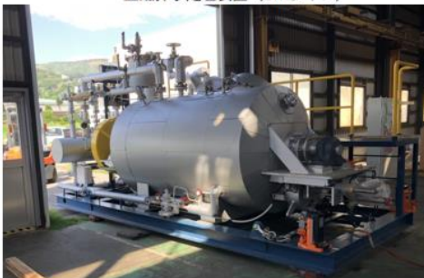
亜臨界水処理装置 (3mタイプ)
