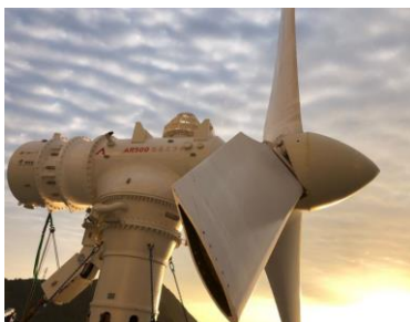
潮の運動エネルギーを使い、ブレードを回して発電する（出所：九電みらいエナジー）
